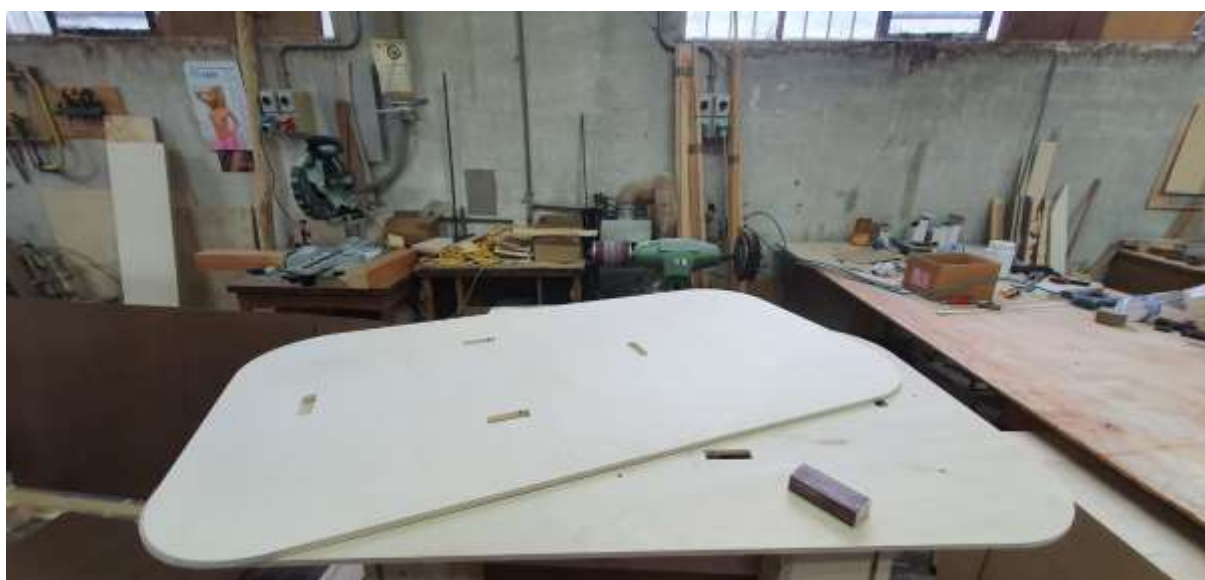
Realizzazione pannello rivestito con tessuto idro-oleorepellente
