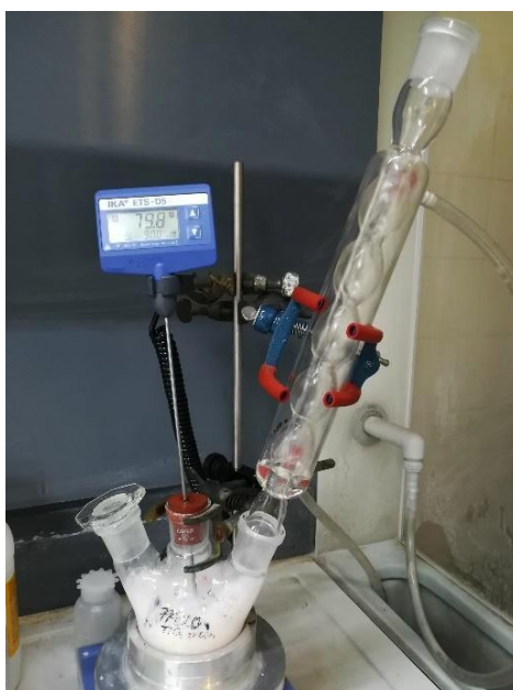
Figura 1 – Apparato per la sintesi delle nanoparticelle (NP1).
